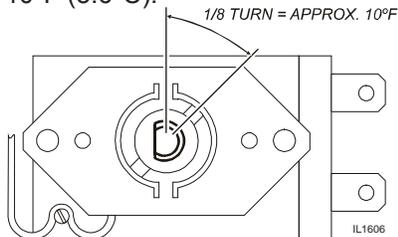
Fig. 11 Adjust Thermostat
