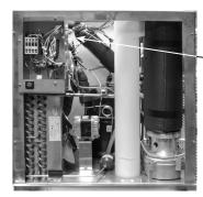
BIN THERMOSTAT IS LOCATED ON SIDE OF CONTROL BOX
